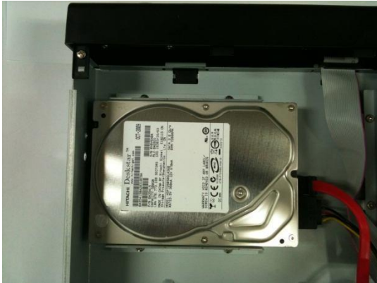
5. HDD'nin güç ve veri kablosu bağlandıktan sonra,
