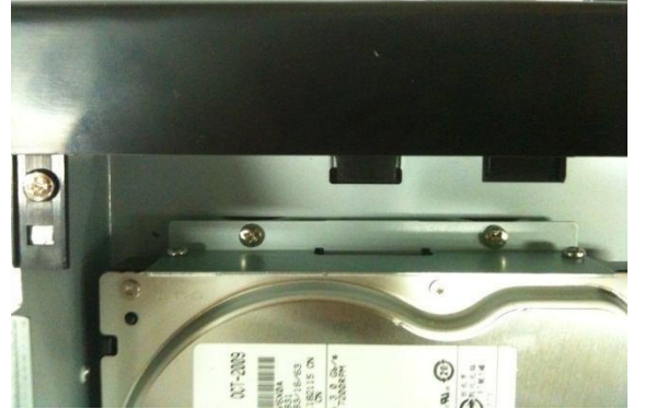
4. HDD montaj kulakları ile HDD'nin cihaza montajı,
