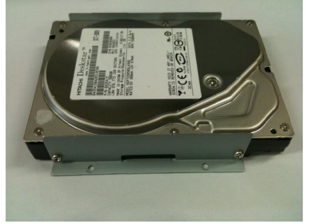
2. HDD Montaj kulaklarına HDD'yi montajladıktan sonra,
