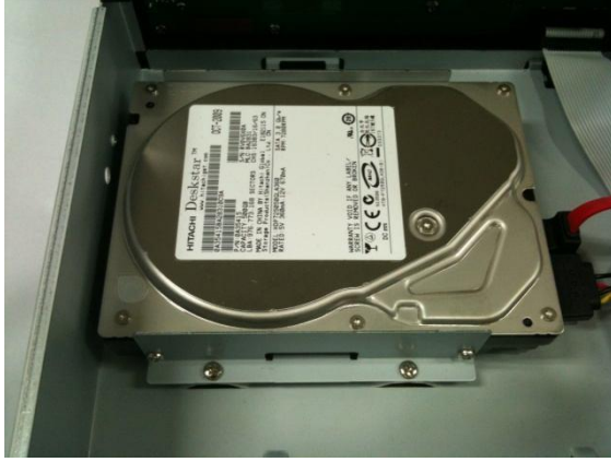
3. Cihaz içerisinde HDD montaj konumu,
